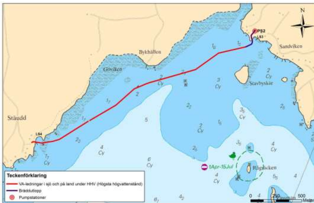
Figur 3. Sökt alternativ för bräddutlopp från pumpstation 2.
