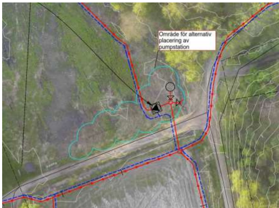
Figur 2. Sökt alternativ för bräddutlopp från pumpstation 1.
